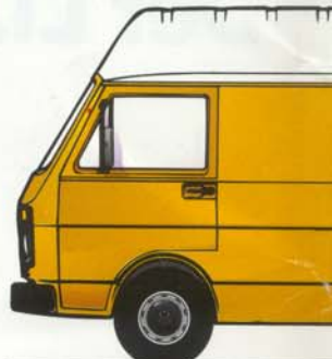
LT Hochraum-Kastenwagen gibt es als LT 28, 31, 35, 40 und 45. Zulässige Gesamtgewichte: 2.800 bis 4.600 kg; Nutzlasten: 905 bis 2.470 kg. Radstände:
