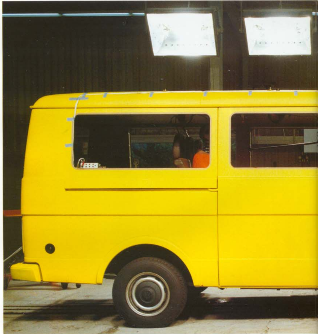
Verzinktes Stahlblech: Frontpartie (partiell), Fahrer- und Beifahrertür, Schiebetür und Gleitschiene.
