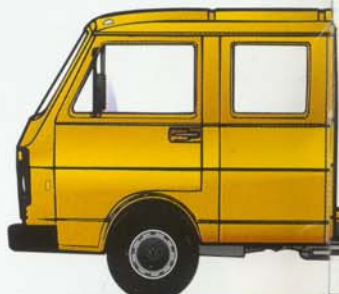
LT Fahrgestell mit Doppelkabine gibt es als LT 28, 31, 35, 40, 45, 50 und 55. Zulässige Gesamtgewichte: 2.800 bis 5.600 kg; Tragfähigkeiten: 1.060 bis
