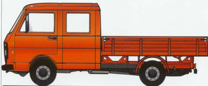
LT Pritsche mit Doppelkabine gibt es als LT 28, 31, 35, 40, 45, 50 und 55. Zulässige Gesamtgewichte: 2.800 bis 5.600 kg; Nutzlasten: 845 bis 3.245 kg. Radstände: 2.950 und 3.650 mm. Sitzplätze für bis zu 7 Personen. Ladelänge: 2.515 bzw. 3.750 mm. Ladebreite: 2.015 mm. Zulässige Anhängelasten bis 2.500 kg.
