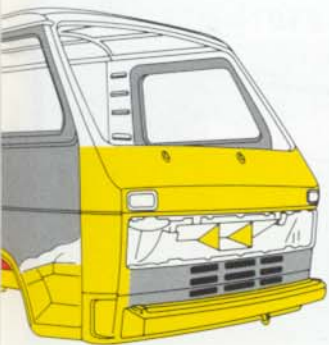
Hohlraumversiegelung: Türen (unterer Bereich) und Deformationselement.
