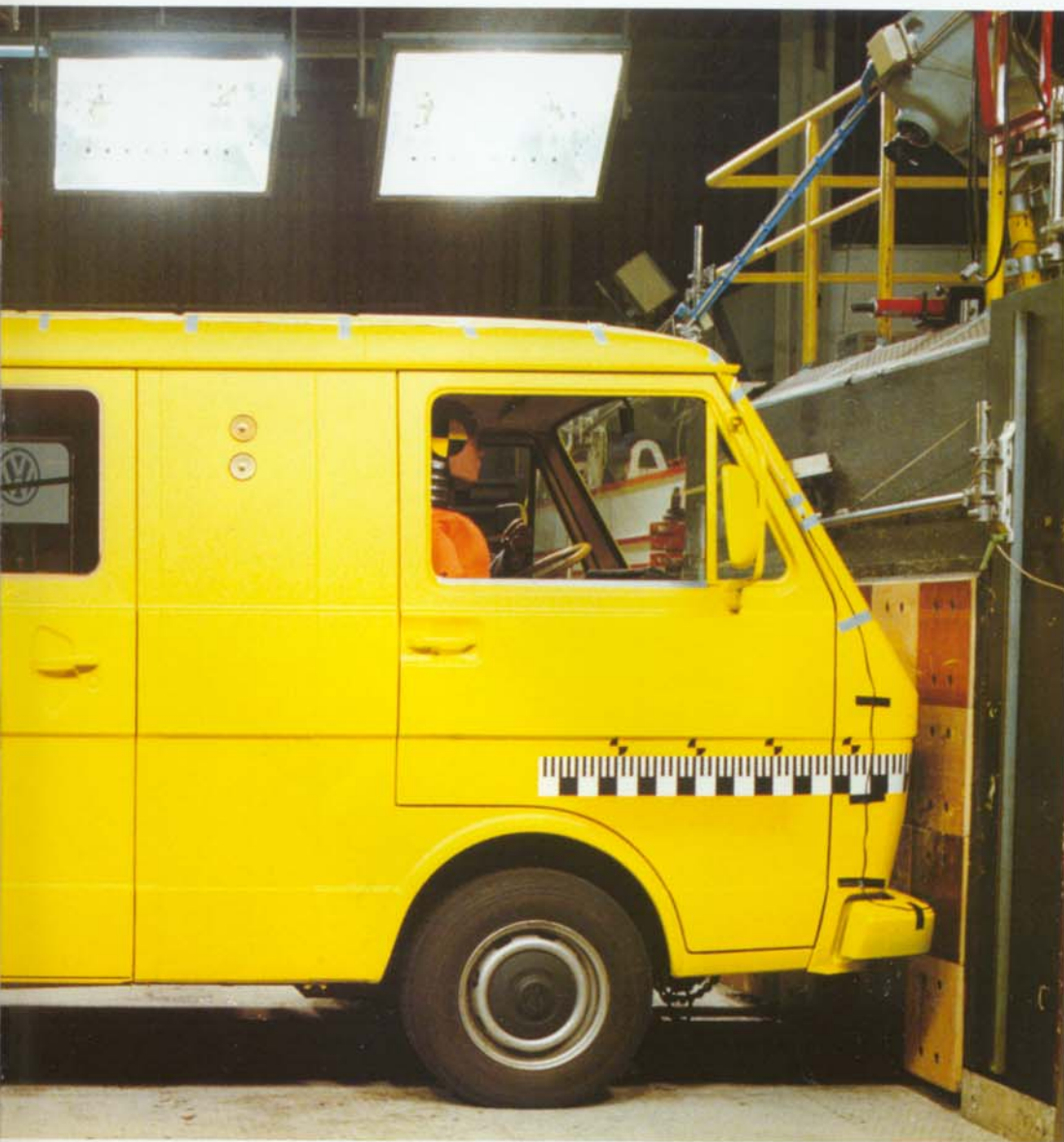
Verformungstöpfe bei den Modellen LT 28 - LT 35 sorgen bei einem Aufprall für einen Abbau der Aufprallenergie.
