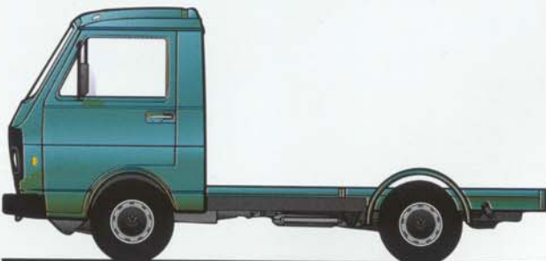
LT Fahrgestell mit Fahrerhaus gibt es als LT 28, 31, 35, 40, 45, 50 und 55. Zulässige Gesamtgewichte: 2.800 bis 5.600 kg; Tragfähigkeiten: 1.235 bis 3.695 kg. Radstände: 2.500, 2.950 und 3.650 mm. Zulässige Anhängelast bis 2.500 kg. Lieferbar für Sonderaufbauten unterschiedlichster Art.
