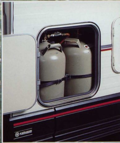
Die Gasvorratskammer – Raum für zwei 11-kg-Behälter.
