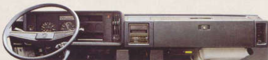
Instrument och reglage är logiskt utformade och placerade. Det innebär att instrumen- ten är riktade mot föraren i en välvd del - skyddade mot reflexer. Stora friskluftinsläpp ger intriå sidorutor - även under värsta tänkbara förhållanden.
