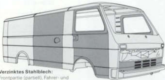
Steinschlagschutz PVC: Frontpartie, Radaussparungen, Trittstufen und Radkästen.
