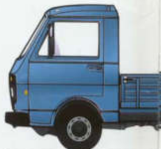
LT Tieflader gibt es als LT 28, 31 und 35. Zulässige Gesamtgewichte: 2.800 bis 3.500 kg; Nutzlasten: 1.050 bis 1.695 kg.
