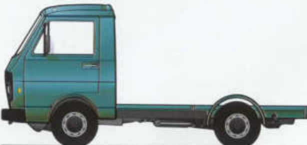
LT Fahrgestell mit Fahrerhaus gibt es als LT 28, 31, 35, 40, 45, 50 und 55. Zulässige Gesamtgewichte: 2.800 bis 5.600 kg; Tragfähigkeiten: 1.235 bis 3.695 kg;
