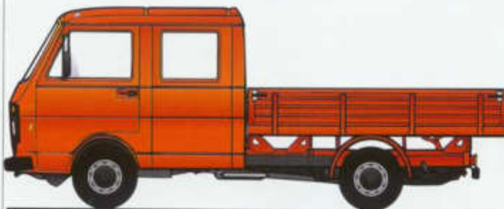
LT Pritsche mit Doppelkabine gibt es als LT 28, 31, 35, 40, 45, 50 und 55. Zulässige Gesamtgewichte: 2.800 bis 5.600 kg; Nutzlasten: 845 bis 3.245 kg; Rad-
