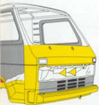
Hohlraumversiegelung: Türen (unterer Bereich) und Deformationselement.
