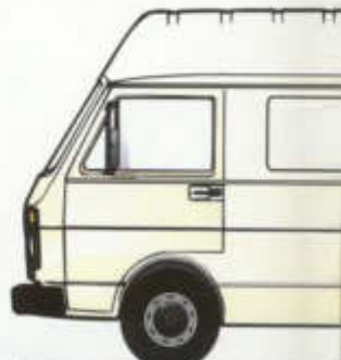
Speditions-Kombi LT 28. Zulässiges Gesamtgewicht: 2.800 kg; Nutzlasten: 875 bis 945 kg; Radstand: 2.950 mm.
