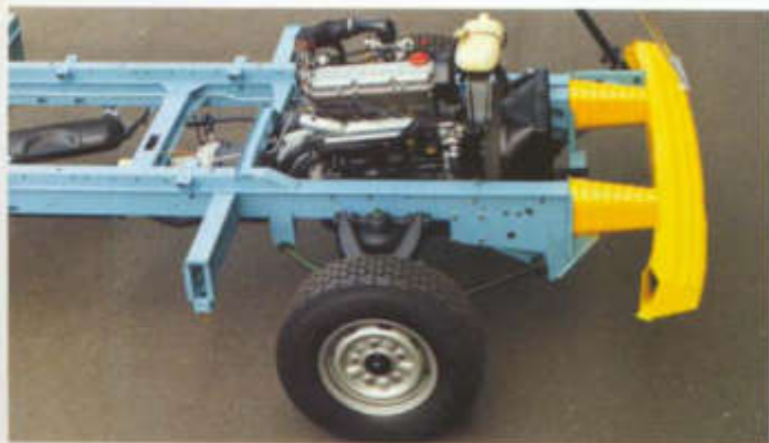
Verformungstöpfe bei den Modellen LT 28 - LT 35 sorgen bei einem Aufprall für einen Abbau der Aufprallenergie.
