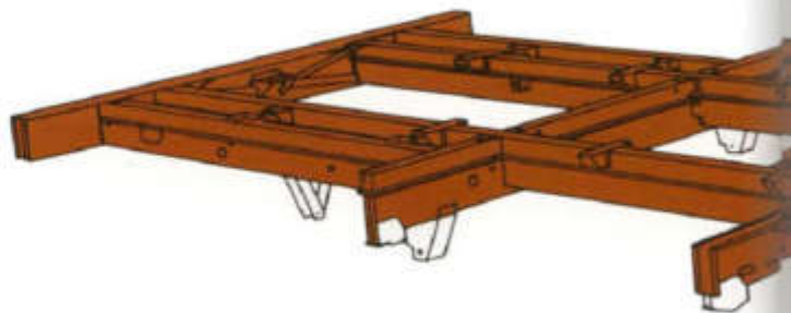
Steinschlagschutz, Hohlraumversiegelung, Unterbodenschutz: Bodengruppe, Fahrgestell (Längs- und Querträger)
