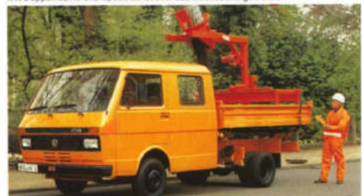
Als Doppelkabine mit Dreiseiten-Kippaufbau und montiertem Schachtkuli.
