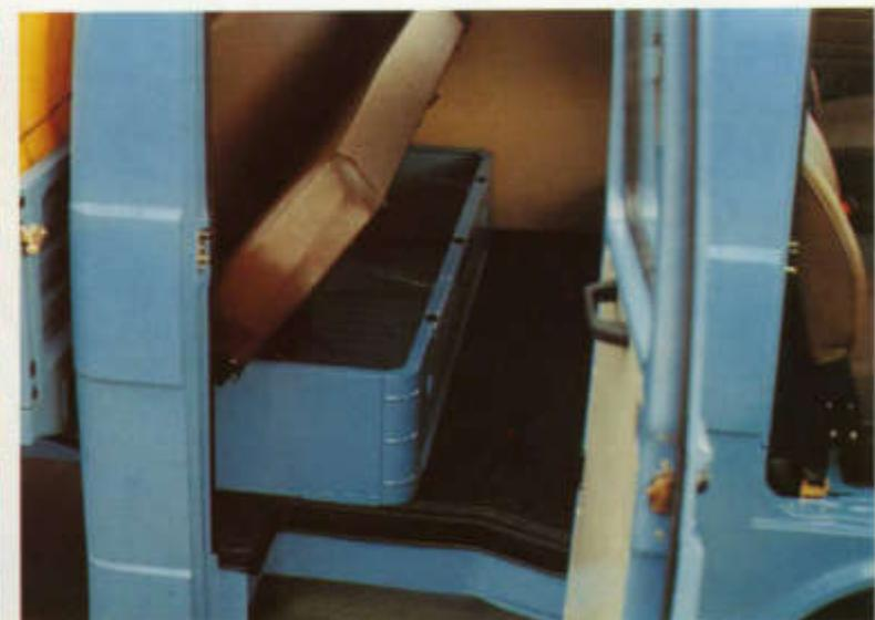
Großer Staukasten unter der neuen viersitzigen Bank in der zweiten Kabine: zur sicheren Unterbringung von Werkzeugen und Geräten.
