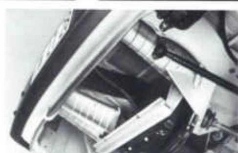
Die Deformationselemente vorn.
